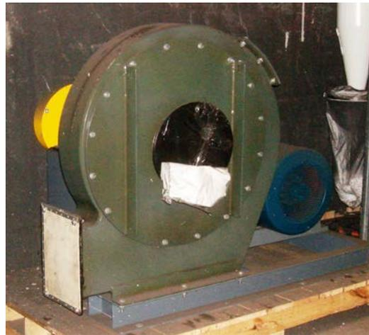
Pyrohydrolysis off-gas fan
